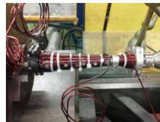
(b) Partie gauche du ralentisseur terminée et collé, et partie droite en cours. Le tout est tenu par des serre-flex le temps que la colle sèche. On voit que sur le bord gauche la forme de l’enroulement ne respecte pas très bien des formes de spires circulaires.
