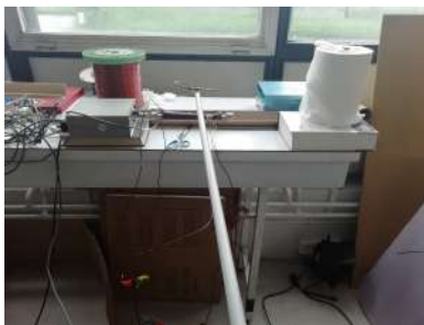
(a) Prise de mesure du champ magnétique à l'extérieur du ralentisseur Zeeman.
