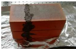
(c) La brique de mortier en figure (b) a ensuite été entouré par deux briques réfractaires découpées par l'atelier d'optique.
