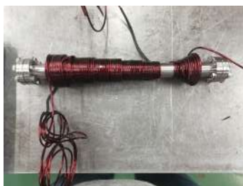
(c) Ralentisseur Zeeman terminé. On a utilisé de la colle epoxy (résistante jusqu’à 235°C) pour fixer les fils.
