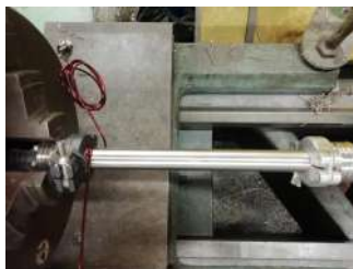
(a) Premiers tours autour du tube pour la partie gauche (partie où circulera un courant positif).
