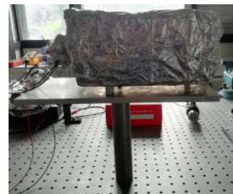
(d) Photo du four terminé, posé sur des cales pour ajuster sa hauteur, sur une plaque sur-élevée. Les fils sortent du four par des rainures réalisés dans la brique par l'atelier d'optique. Pour les protéger, les fils de Nickel chrome passent par des tubes fins en alumine puis ont été gainés.
