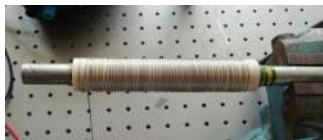
(a) Fil de Nickel-Chrome entourant le tube d'alumine.
